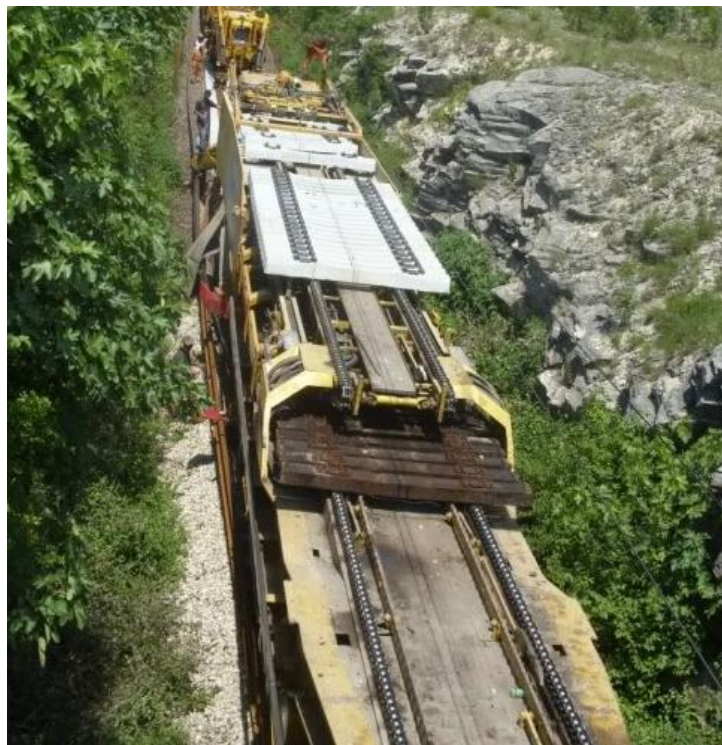
Slika 11. Transportne trake na stroju za nove i stare pragove
