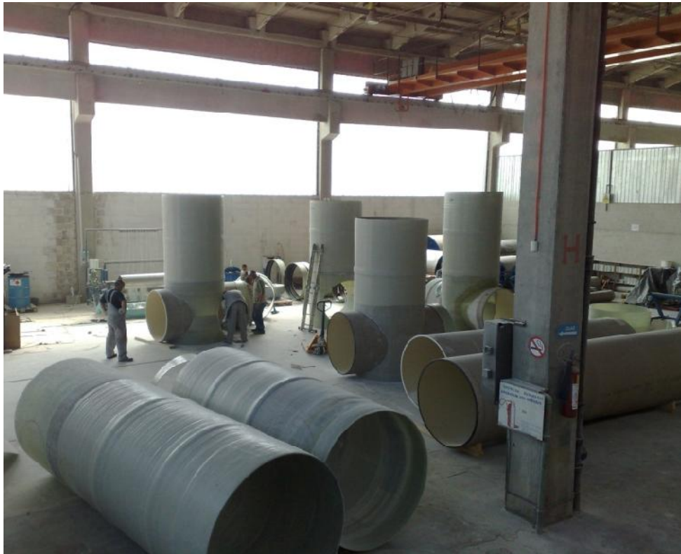
Slika 6. Proizvodni pogon-Revizionna okna
