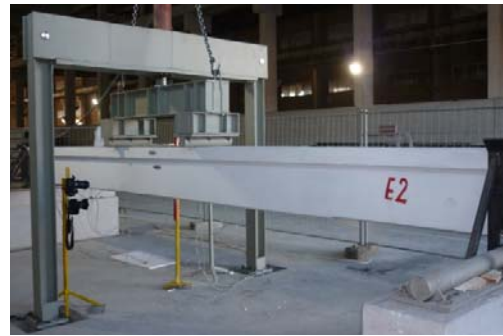
Slika 7. Shema opterećivanja nosača
