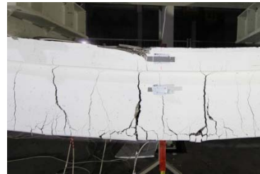
Slika 8. Fotografije nekih greda tip E u sredini raspona nakon sloma
