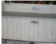
F=163\text{kN}; w_c = 2,7\text{mm}
