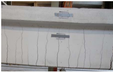
Slika 8. Fotografije nekih greda tip E u sredini raspona nakon sloma
