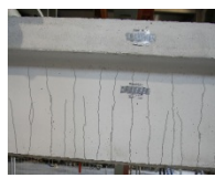
F=150\text{kN}; w_c = 0,4\text{mm}
