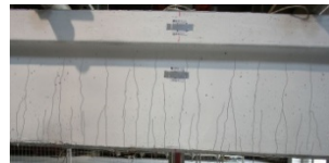
F=150\text{kN}; w_c = 0,25\text{mm}
