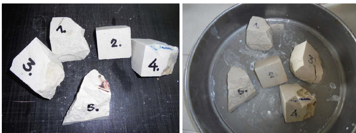
Slika 4. Uzorci serije 2. prije i nakon ispitivanja upotrebom rastvora natrijum-sulfata
