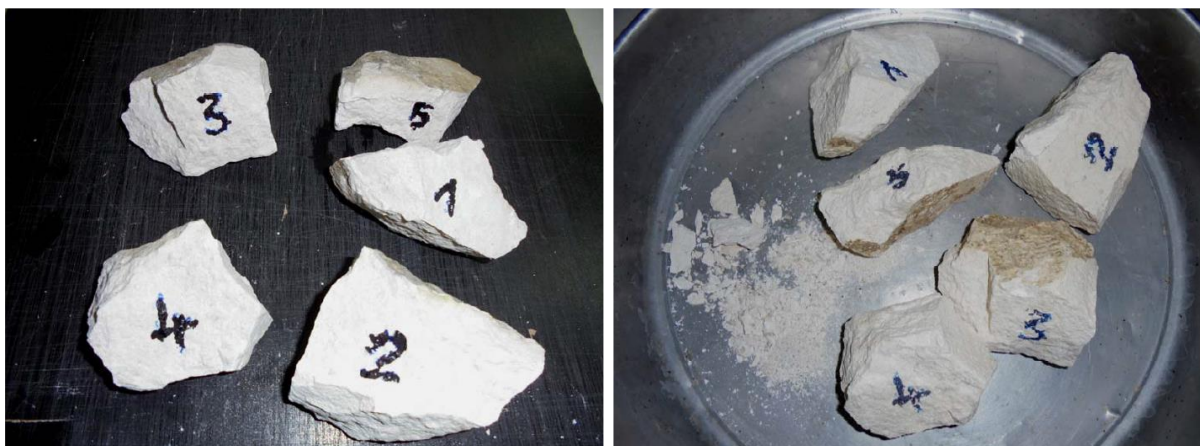
Slika 3. Uzorci serije 1. prije i nakon ispitivanja upotrebom rastvora natrijum-sulfata
